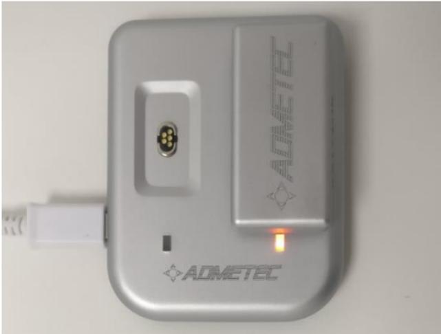
**Abbildung 2: Akkupack ist an das Ladepad angeschlossen**
