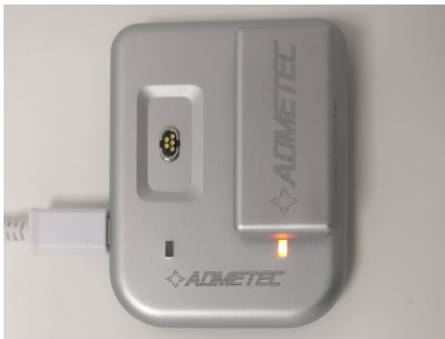
Abbildung 2: Akkupack ist an das Ladepad angeschlossen
