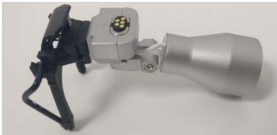
Abbildung 7: Lichtquelle an der Universalklammer befestigt
