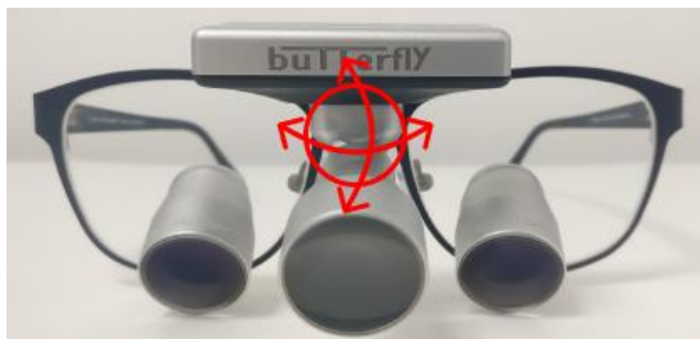
Abbildung 9: Stirnlampe auf Lupenrahmen montiert
