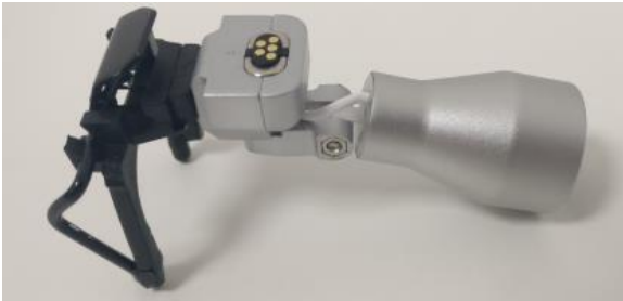
Εικόνα 7: Σύνδεση πηγής φωτός σε γενικό σύνδεσμο
