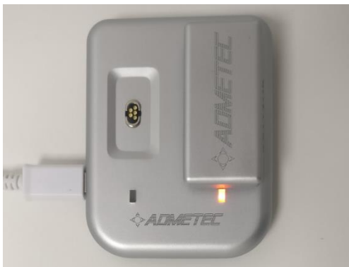
Εικόνα 2: Συστοιχία συσσωρευτών συνδεδεμένη στο πέλμα φόρτισης
