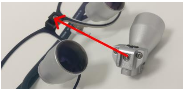
Εικόνα 6: Σύνδεση του προβολέα σε σκελετό με λούπες
