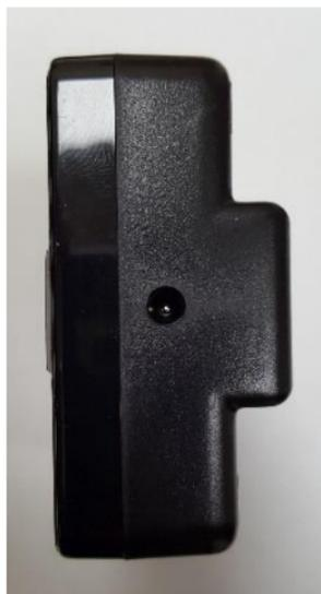
Puerto de conexión del cargador
