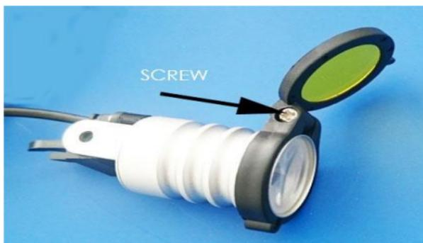
Figure 8 : Montage d'un filtre jaune externe
