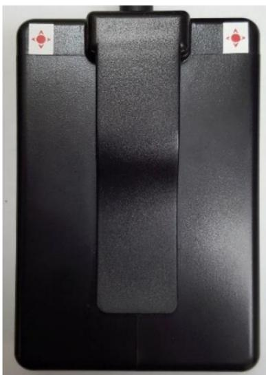
Figure 5 : Panneau arrière avec clip de ceinture
